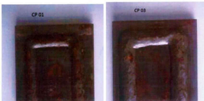
Figura 5.3 – Cordões de solda realizados com o consumível E71T-1 (FCAW) bitola 1,2 mm nas respectivas correntes: CP01: 236,6A e CP02: 340,9A
