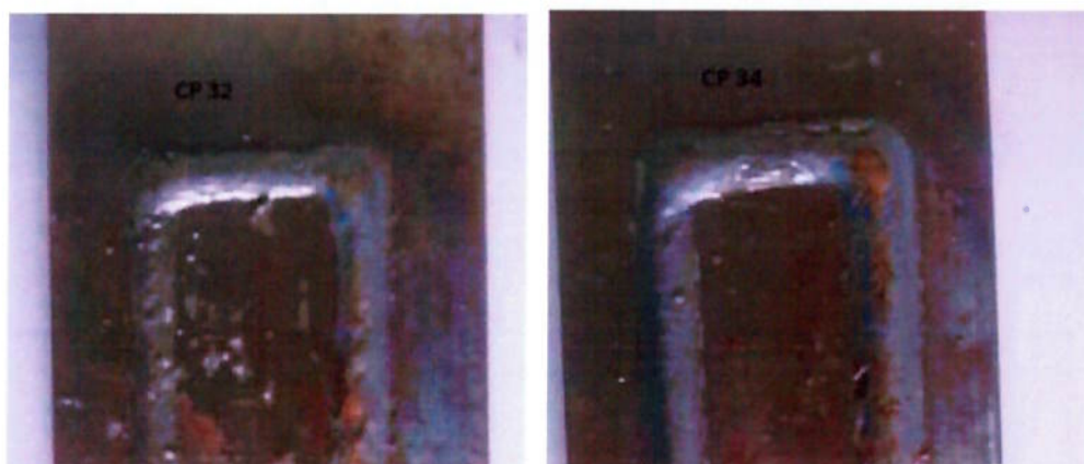
Figura 5.8 – Cordões de solda realizados com o consumível ER70S-6 (GMAW) bitola 1,6 mm nas respectivas correntes: CP32: 276,8A e CP34: 362,9A
