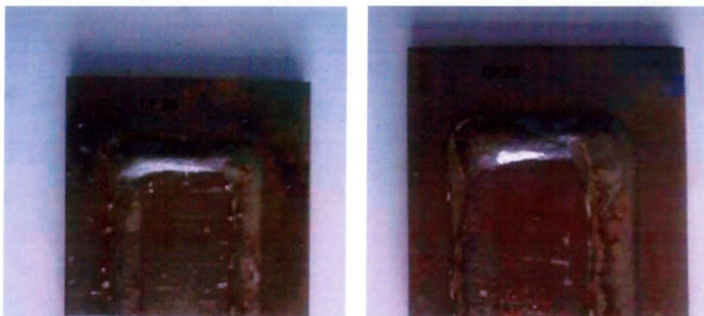
Figura 5.7 – Cordões de solda realizados com o consumível ER70C6-C (METAL CORED) bitola 1,6 mm nas respectivas correntes: CP26: 304,4A e CP28: 450A
